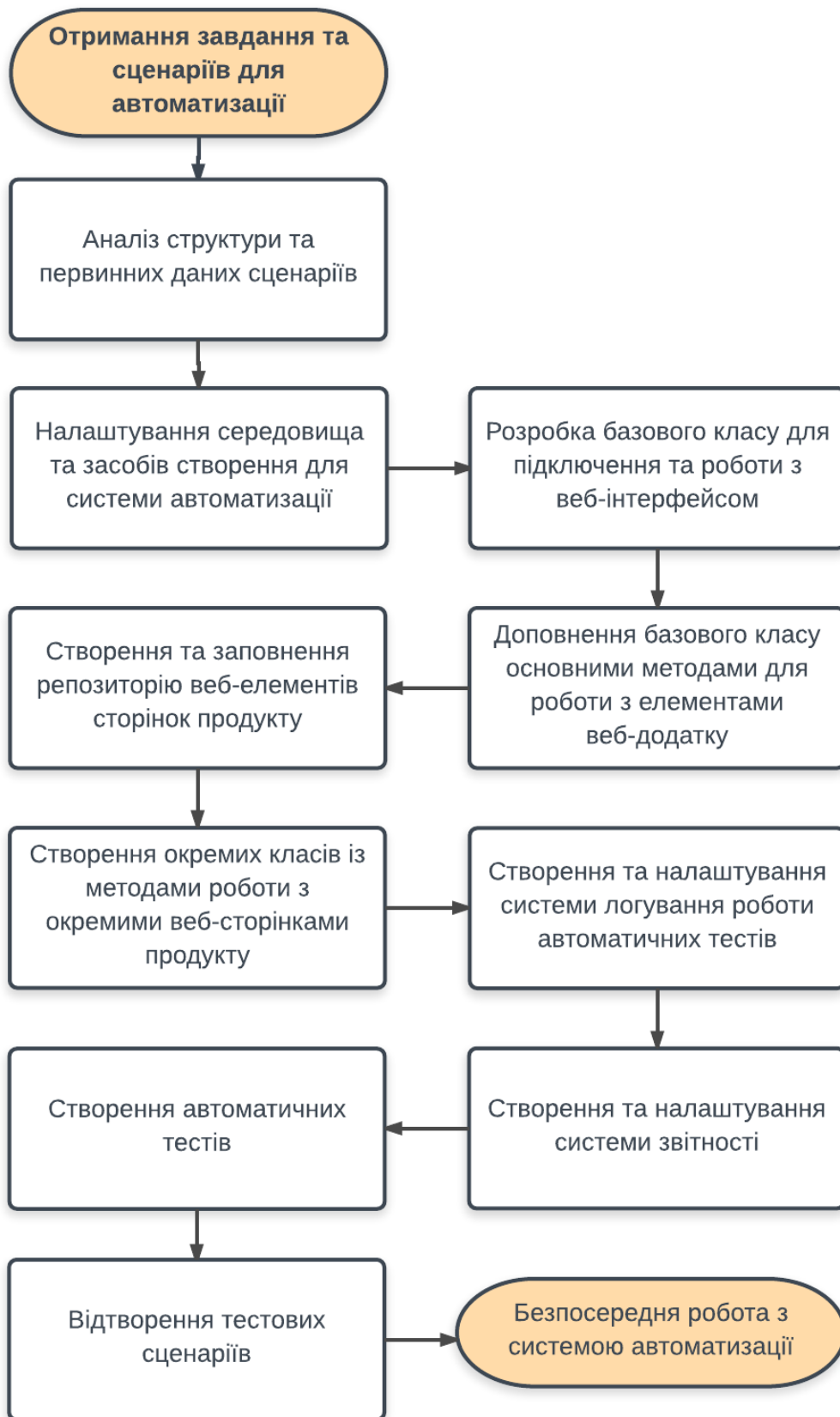
Рисунок 11 – Алгоритм розробки системи автоматизації із використання спеціальних методологій та практик
